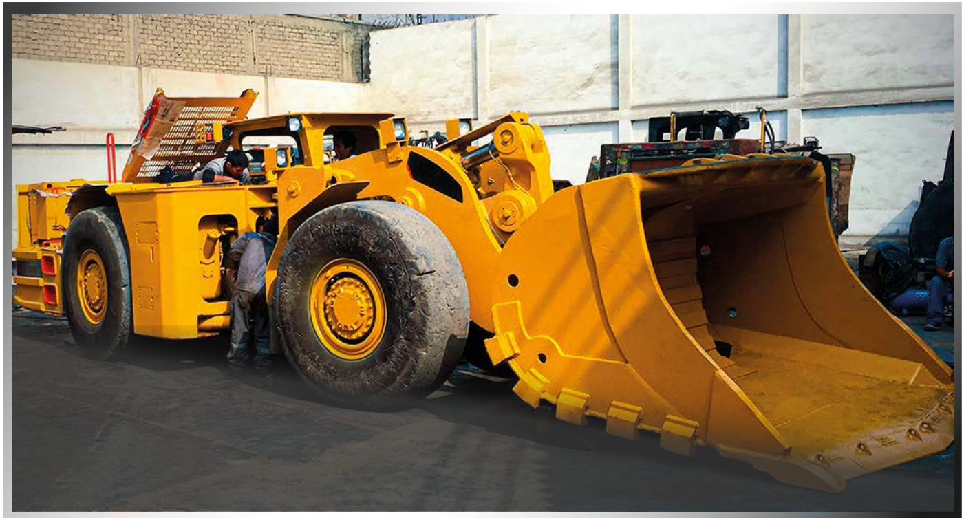
Reparación Total (Overhaul) del Cargador Frontal de Bajo perfil Scoop R1600. Se entrega con garantía de equipo nuevo
